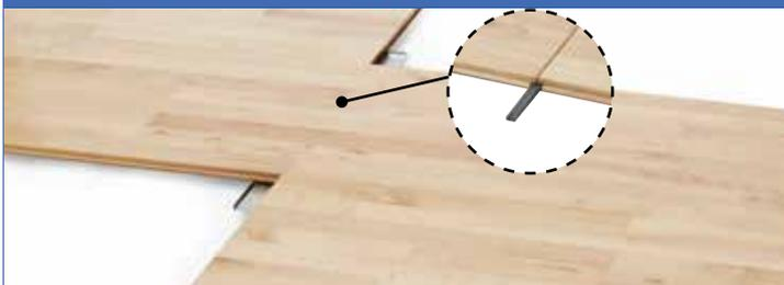
Les panneaux sont assemblés par bouvetage dans le sens de la longueur à l'aide de fausses languettes au niveau des extrémités.
