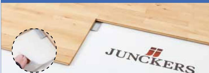
Les panneaux sont assemblés en pose flottante sur une sous couche sportive de 10mm. Cette couche de mousse intermédiaire est nécessaire pour obtenir une absorption des chocs et une élasticité correctes.
